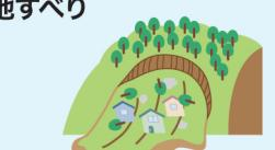
雨や雪解け水が地下にしみ込み、断続的に斜面が滑り出す現象。
